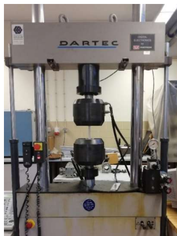
Figura 3.3. Máquina servo-hidráulica Dartec usada nos ensaios de fadiga.
