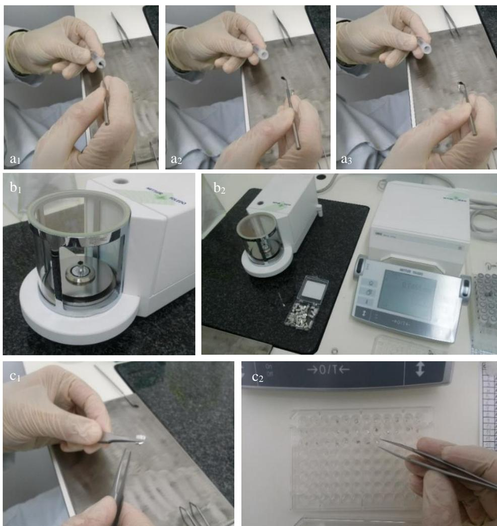
Figura II.18. Pesagens; a<sub>1</sub>-Retirar resíduo de cápsula de secagem; a<sub>2</sub> e a<sub>3</sub>-Por resíduo em recipiente próprio ao IRMS; b<sub>1</sub> e b<sub>2</sub>-pesagem da amostra; c<sub>1</sub>-empacutamento do recipiente com o resíduo orgânico, c<sub>2</sub>- Resultado final, amostra pronta à passagem no IRMS.
