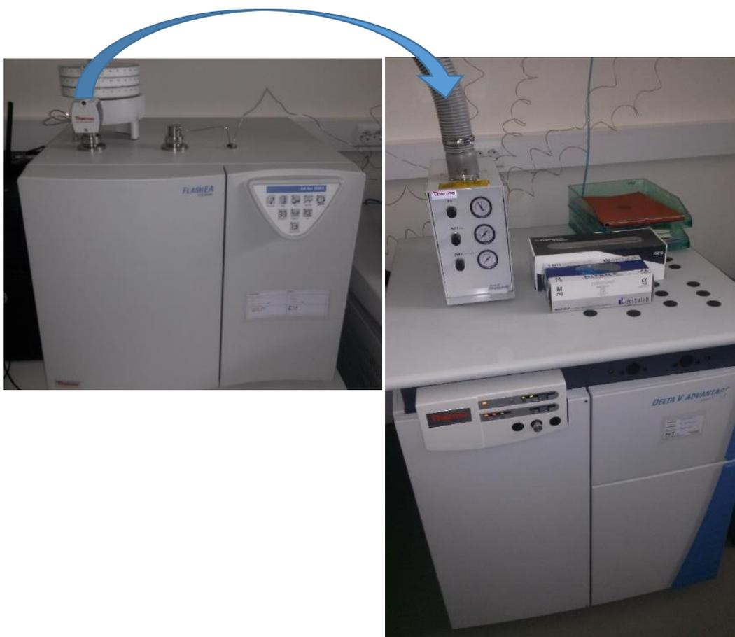
Figura II.16. Espectrómetro de massa (IRMS), do MAREFOZ.
