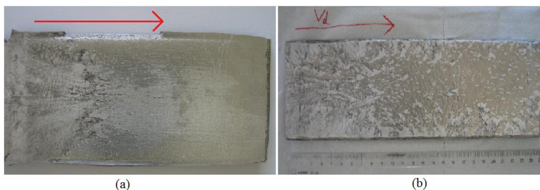
Figura 4.4. Efeito do Rácio na superfície final da soldadura. (a) superfície exterior da EW 14-Al.Fe-3.3; (b) superfície exterior da UEW 22-Al.Fe-3.3.
