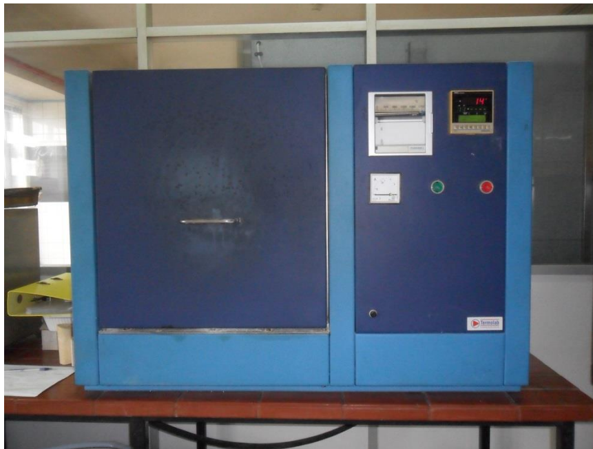
Figura 4.7 Forno de sinterização utilizado. (CTCV)
