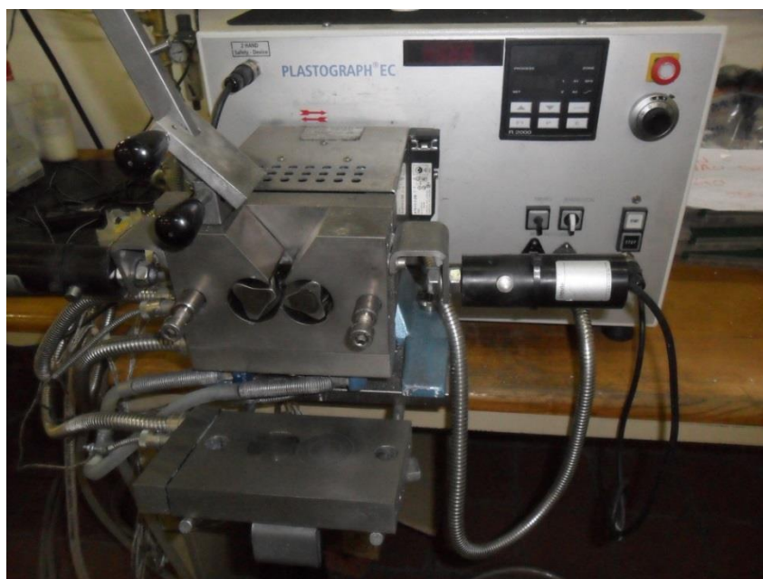
Figura 3.3 Equipamento de reometria de binário: Plastograph EC , Brabender . (CTCV)
