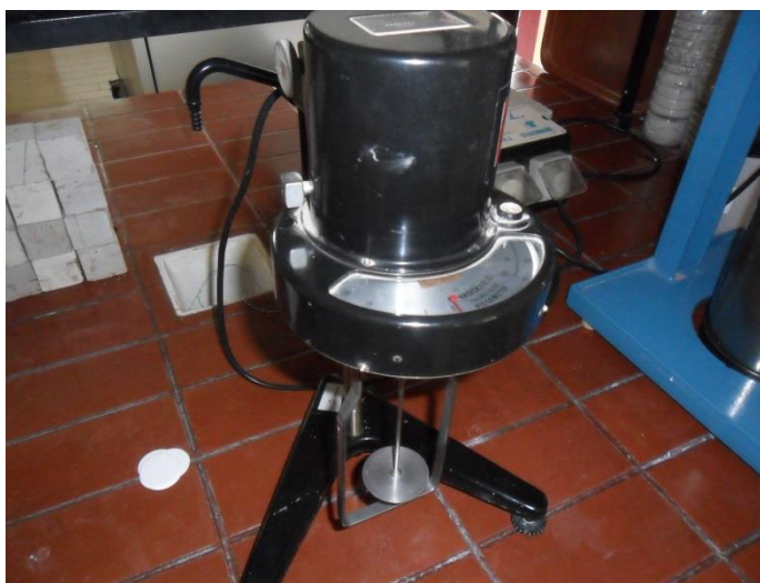
Figura 3.6 Viscosímetro de Brookfield com spindle .
