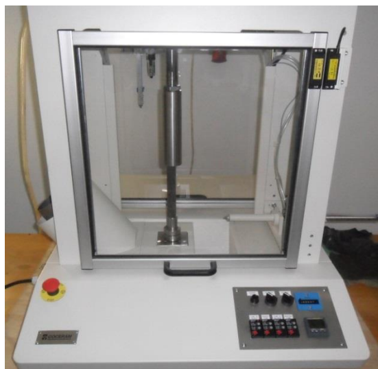
Figura 4.4 Máquina de injeção MPIM Goceram com molde introduzido. (CTCV)
