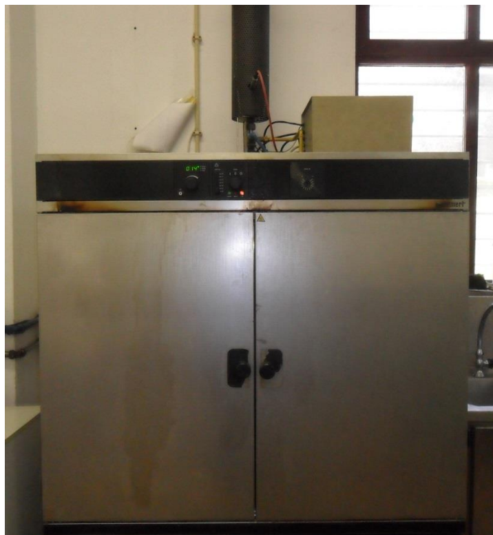
Figura 4.6 Estufa de debinding utilizada. (CTCV)
