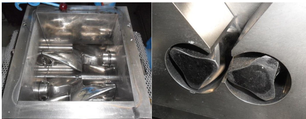
Figura 2.3 Câmaras de mistura de equipamentos: Z-Blade (esquerda) e Plastograph (direita). (CTCV)
