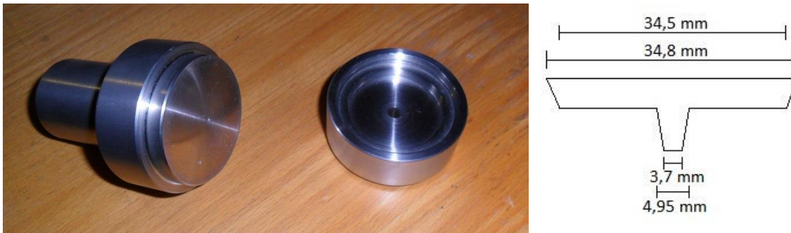
Figura 4.5 Molde de aço inoxidável e dimensões da cavidade de enchimento. (CTCV)
