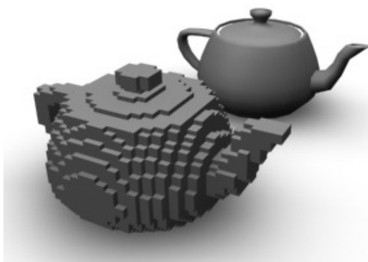
Figura 4.2: Modelos gráfico (a trás) e voxelizado (à frente) de um objecto.
