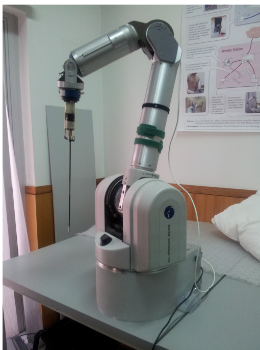
Figura 3.2: Manipulador 7-DOF WAM. Acoplado ao end-effector está a ferramenta médica abordada no capítulo 2.
