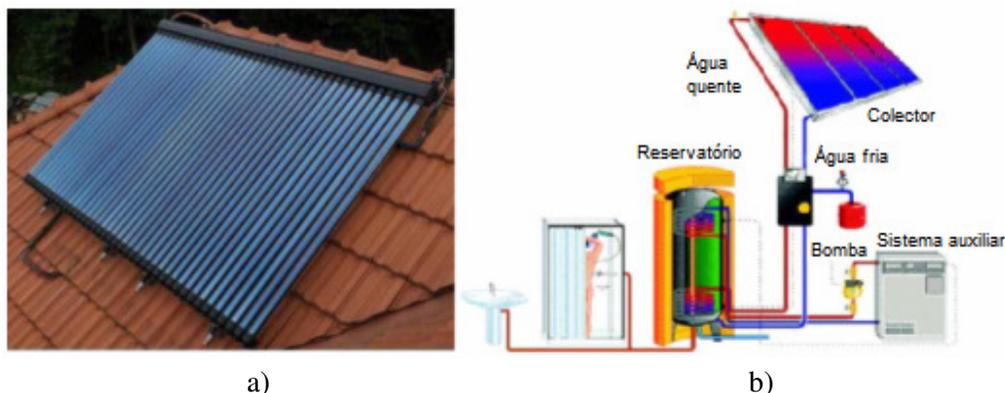
Figura 4.9- a) Colector solar; b) Sistema de funcionamento (NotaPossitiva@, 2013).
