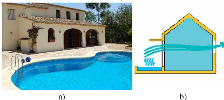
Figura 4.7- a) Sistema evaporativo; b) Esquema de funcionamento (Patrocínio, 2006).
