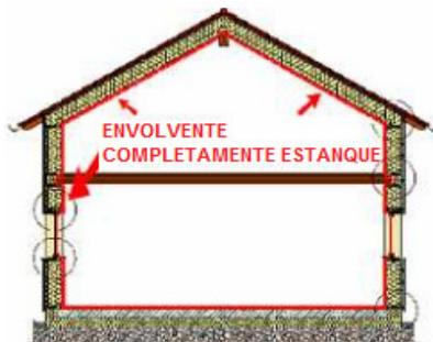
Figura 4.17- Impermeabilidade ao ar (Passivhaus Institut@, 2013).
