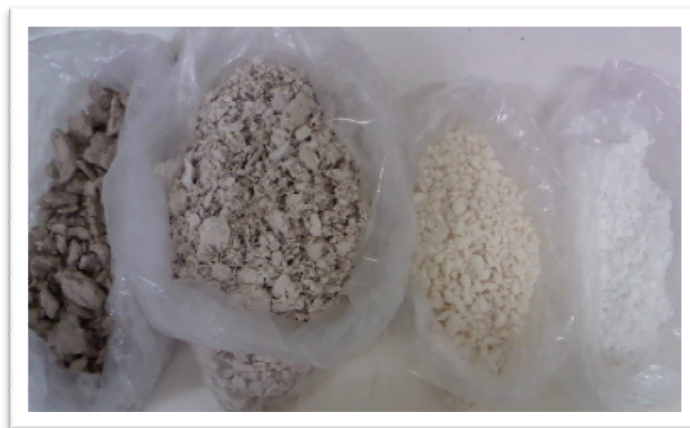
FIGURA 14: Exemplificação da evolução da cor da pasta ao longo de uma sequência de branqueamento.
