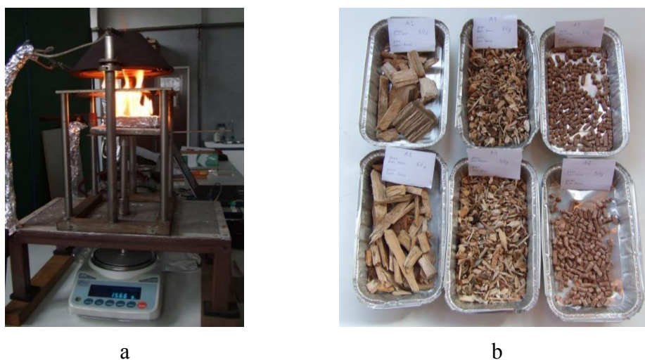
Figura 11 - Ensaio e configuração do calorímetro cónico (a) e amostras para o ensaio: woodchips , estilha de granulometria 3 < d \leq 6\text{mm} , e pellets (b)
