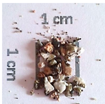
Figura 17 – Resíduos pós-queima de um ensaio de poder calorífico
