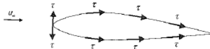
Figura 1 – Tensões tangenciais ao longo de um corpo alar (Santin et al. , 2007).
