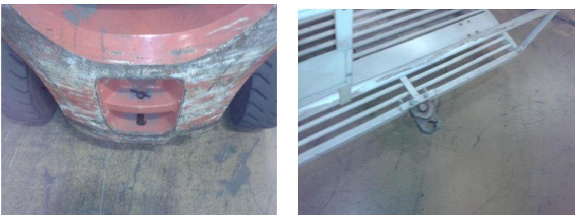
**Figura 5.4 – Encaixes do empilhador e do comboio**
