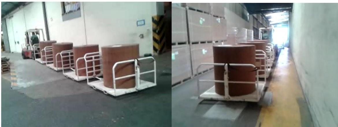
**Figura 5.9 – Comboio a ser testado com o empilhador**
