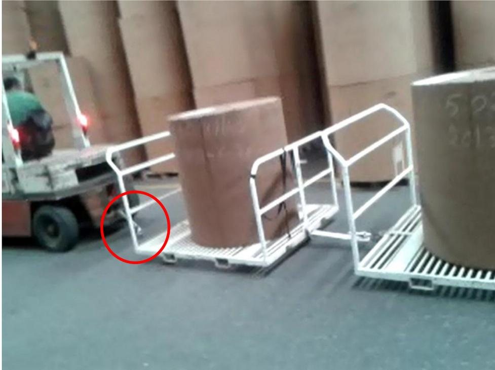
**Figura 5.7 – Peça que une empilhador e carruagem solta**
