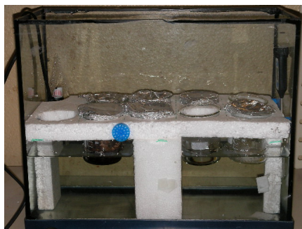
Figura 4.1: Aparato experimental para crescimento de cristais em ambiente controlado
