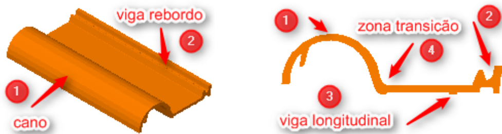
Figura 5.1. Modelo M1: a) perfil, b) perspectiva e c) vista frente.
