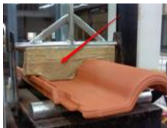
Figura 4.6. Localização da aplicação da carga no protótipo.
