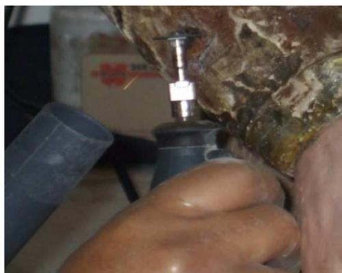
**Fig.63. Polimento dos elementos metálicos**
