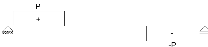
Figura 2.2 - Diagrama de esforço transversal para o carregamento representando na Figura 2.1.
