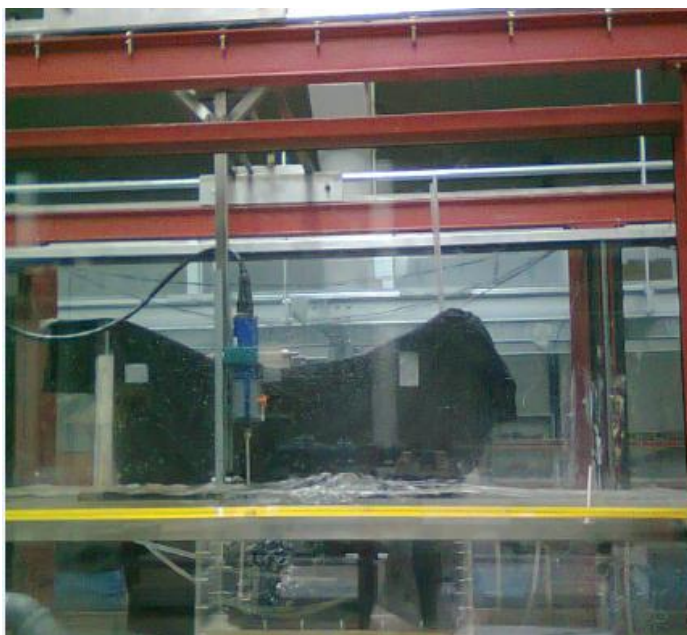
Figura 2.13 – Instalação do ADV
