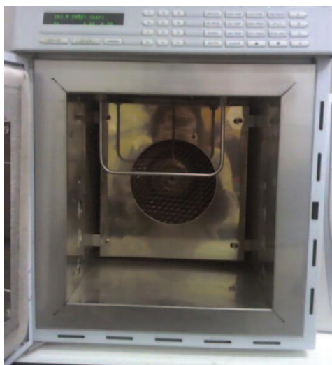
Figura 18: Coluna empacotada dentro do equipamento IGC
