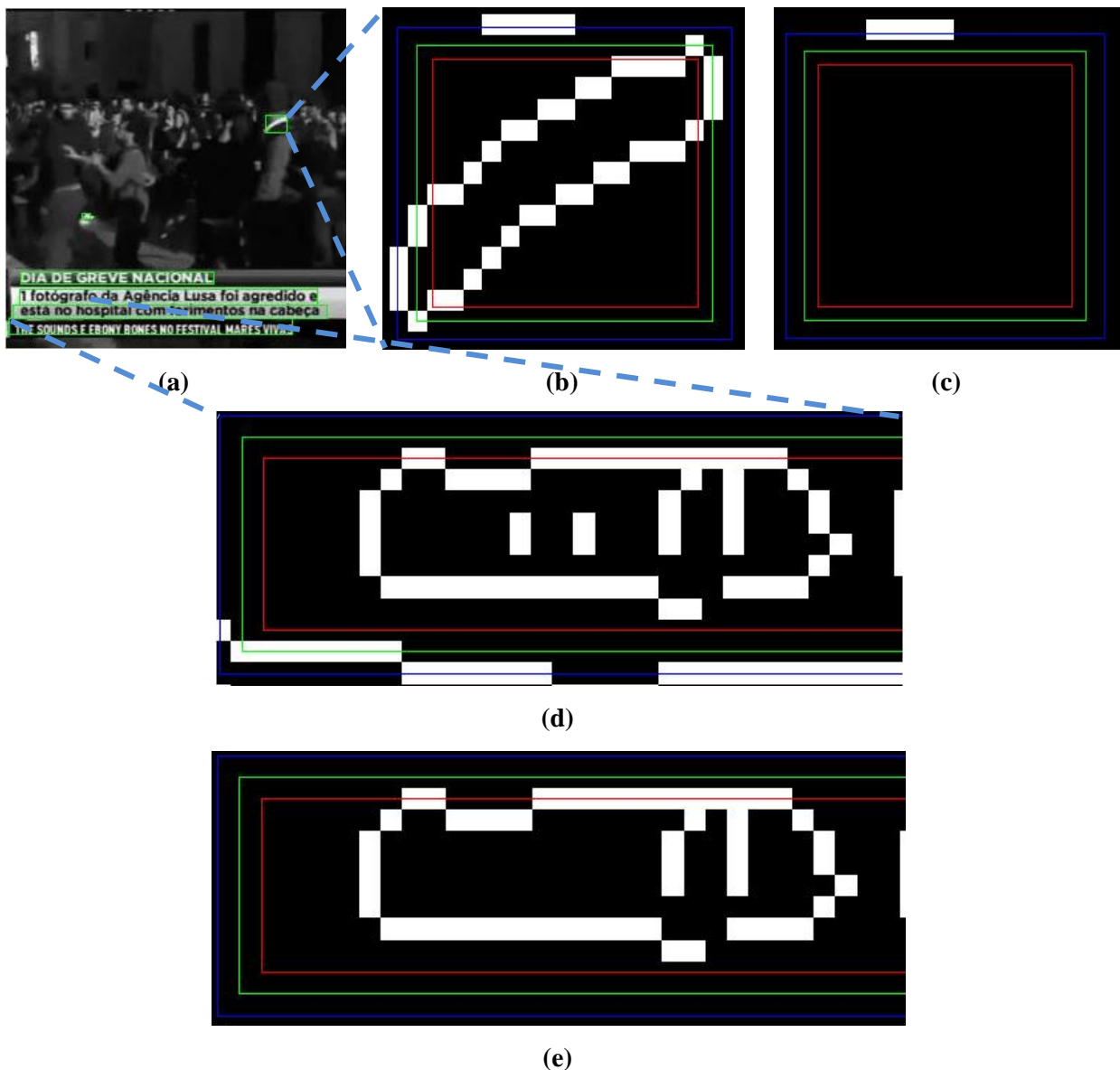
Figura 10. (a) G(x,y) com caixas resultantes do processo de segmentação, (b) Projecção de uma caixa sem texto, (c) Eliminação dos contornos extrínsecos e intrínsecos de (b), (d) Projecção de parte de uma caixa de texto e (e) Eliminação dos contornos intrínsecos e extrínsecos de (d)
