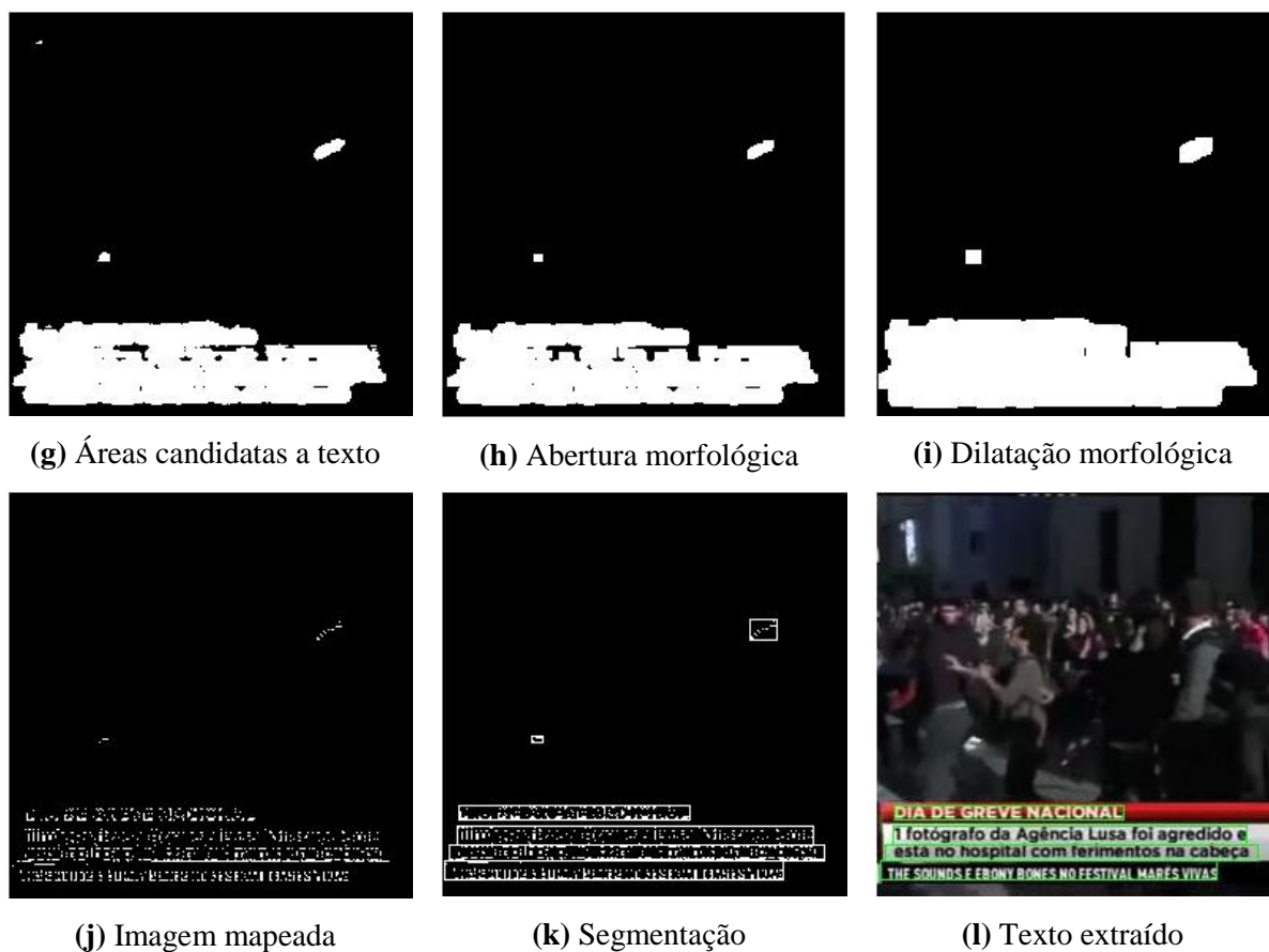
Figura 3. Passos intermediários no processo de detecção de texto pela Wavelet de Haar
