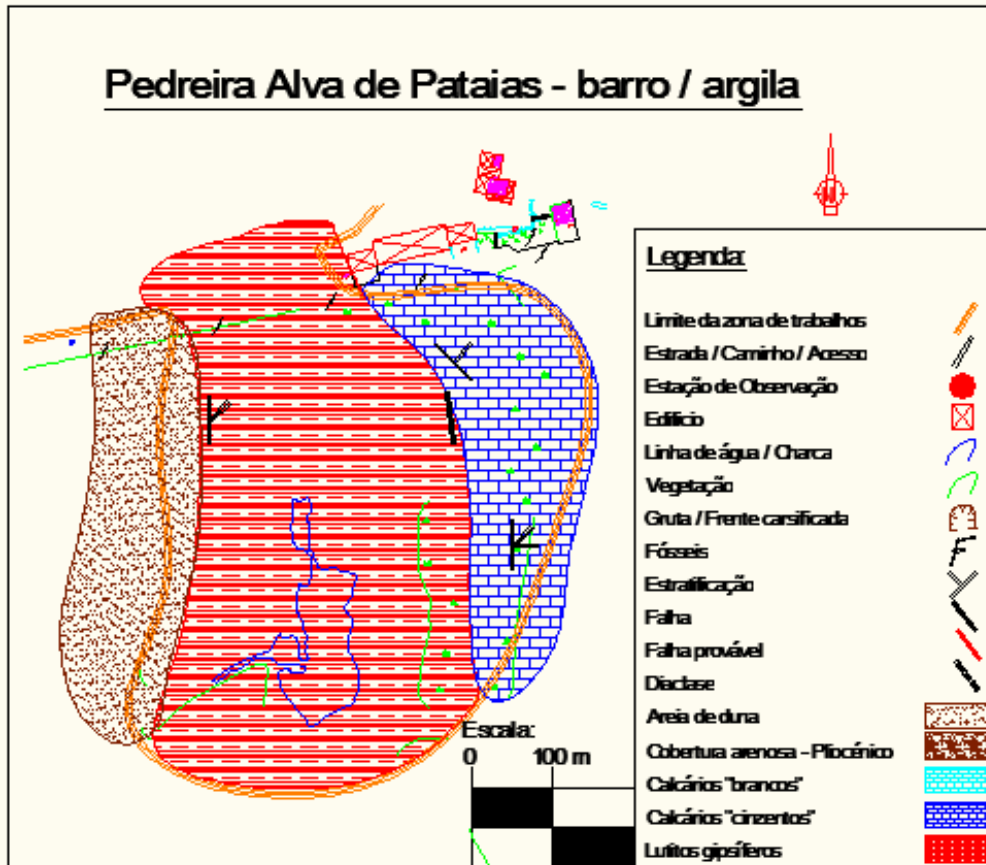
Figura V.13 – Esboço da cartografia geológica da Pedreira de Alva de Pataias – Barro (Formação de Dagorda).
