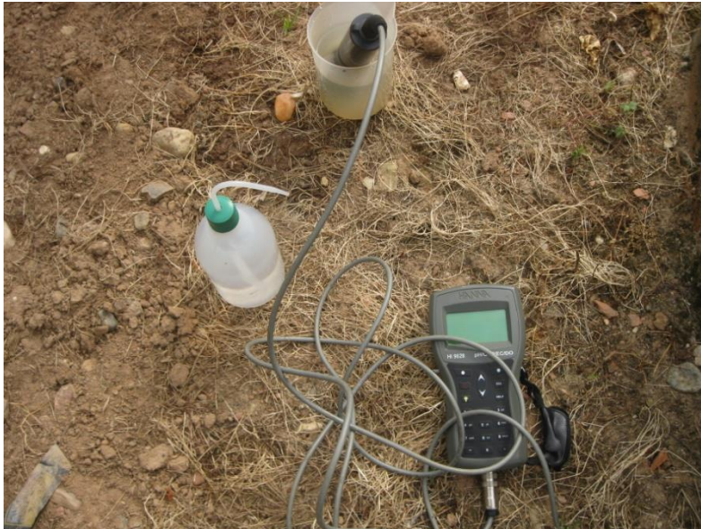
Figura 4.2. – Aparelho multi-parâmetros WTW utilizado nas medições de campo.
