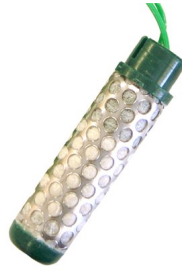
Figura 5.5.: Exemplo do sensor Watermark
