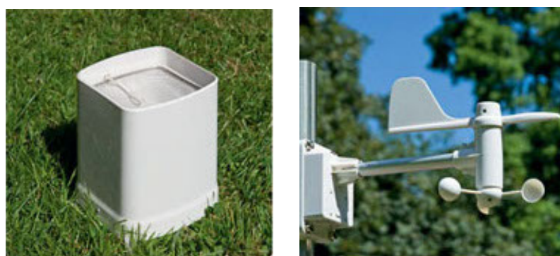
Figura 5.11.: Imagem do pluviómetro e anemómetro
