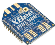
Figura 5.12.: Módulo XBee série 2
