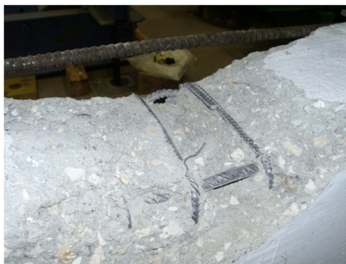
Figura 4.14 – Rotura da Viga 8.
