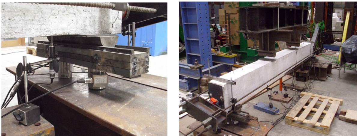
Figura 3.6 – Pormenor do apoio e esquema de ensaio.
