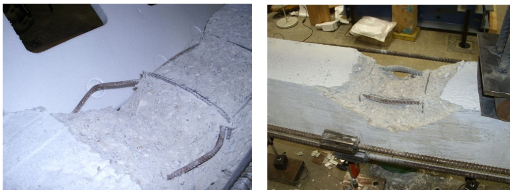
Figura 4.2 – Roturas da Viga 2 2010 e da Viga 5 2010.
