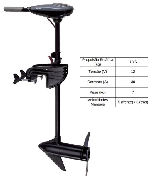
Figura 3.3.: Motor utilizado como propulsor.
