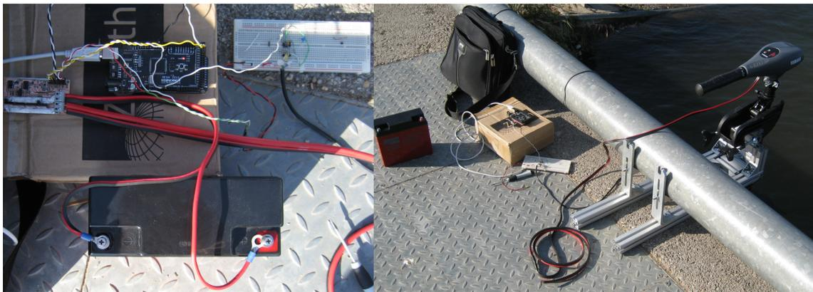
Figura A.7.: Teste da corrente consumida pelos motores.
