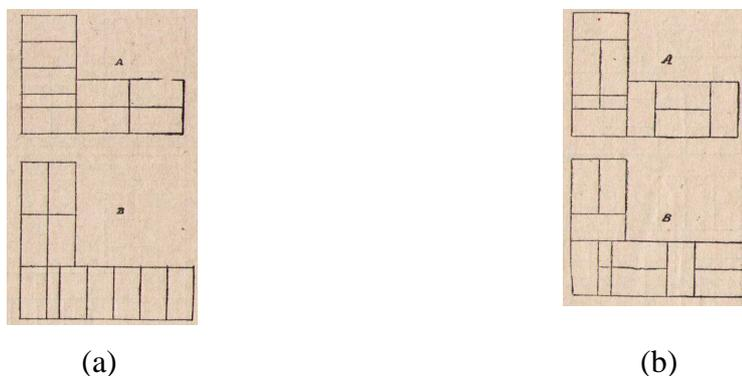
Figura 4.16 – Cunhais em esquadria de paredes de uma vez tijolo (Segurado, s/d-a):
