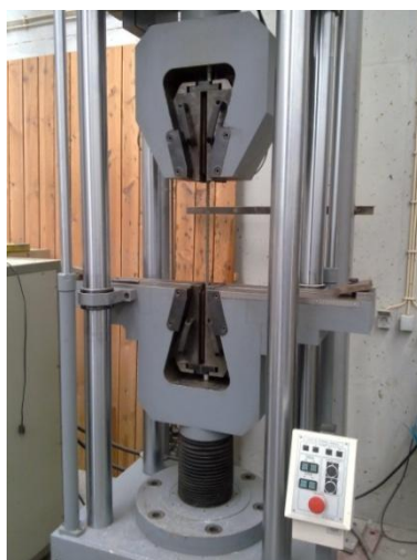
Figura 3.7 – Máquina de tracção usada para medir as características dos provetes de aço.
