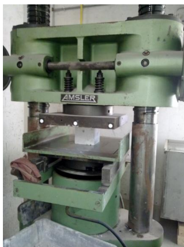
Figura 3.4 – Prensa de ensaios de compressão do betão.
