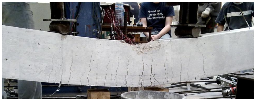
Figura 4.35 - Estado da Viga2 na fase final do ensaio.
