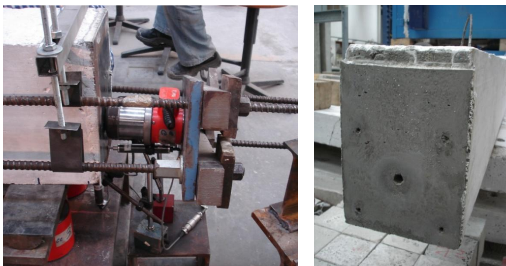
Figura 3.13 – Pormenor do sistema de restrição axial e da chapa de topo da viga.
