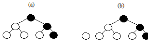
Figura 5 - Aplicação do filtro de Kalman. Os coeficientes sobre os quais o modelo é estimado estão a preto, sendo que a janela desloca-se quando uma nova medição se encontra disponível ( de (a) para (b)).
