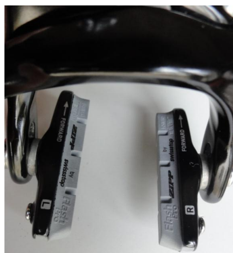
Figura 1.4 Calços Zipp Flash Pro montados em travões caliper SRAM
