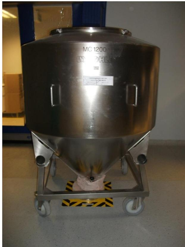
Figura 8 – Contentor de alimentação da mistura para a máquina compressora
