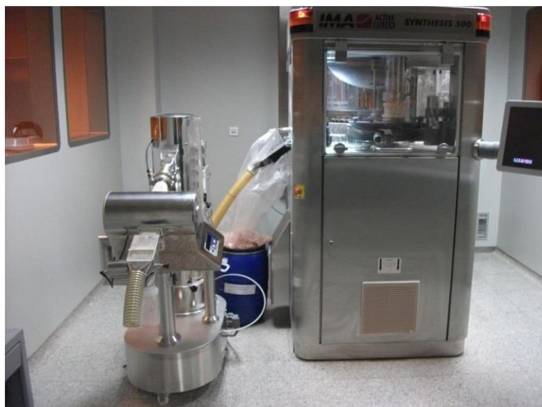
Figura 9 – Máquina Compressora
