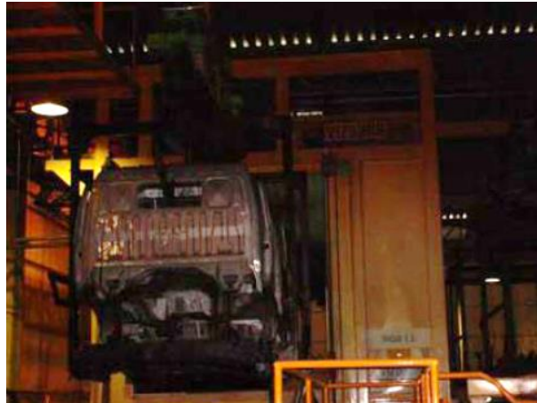
Figura 2.8 Entrada no tanque ED
