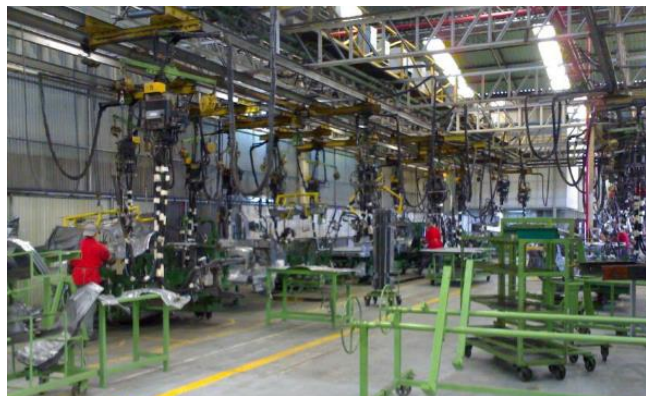
Figura 2.5 Linha de soldadura
