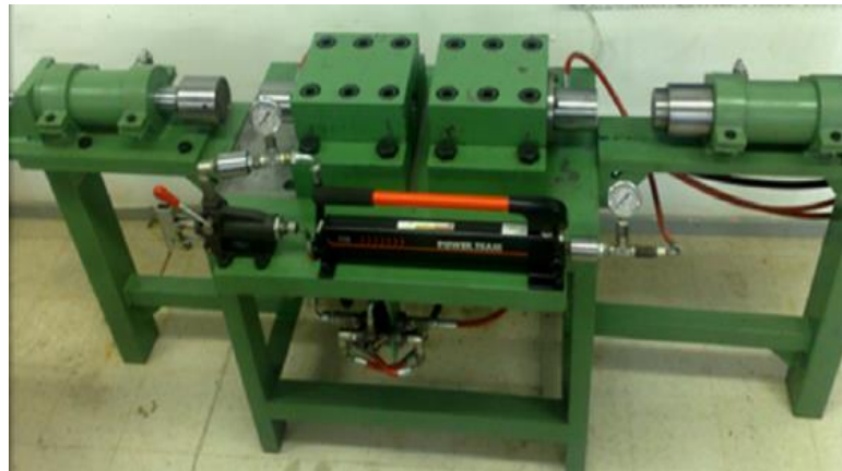
Figura 2.4. Equipamento de hidroformação ( Khalfallah, et al., 2015a ).
