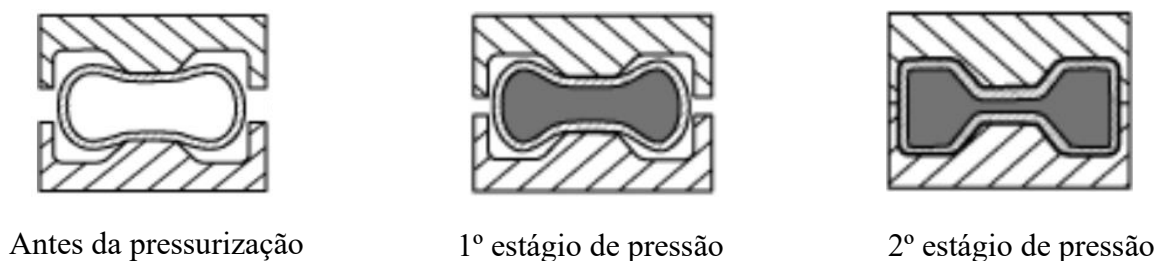
Figura 2.5. Etapas da hidroformação com pressão sequencial ( Morphy, 2001 ).
