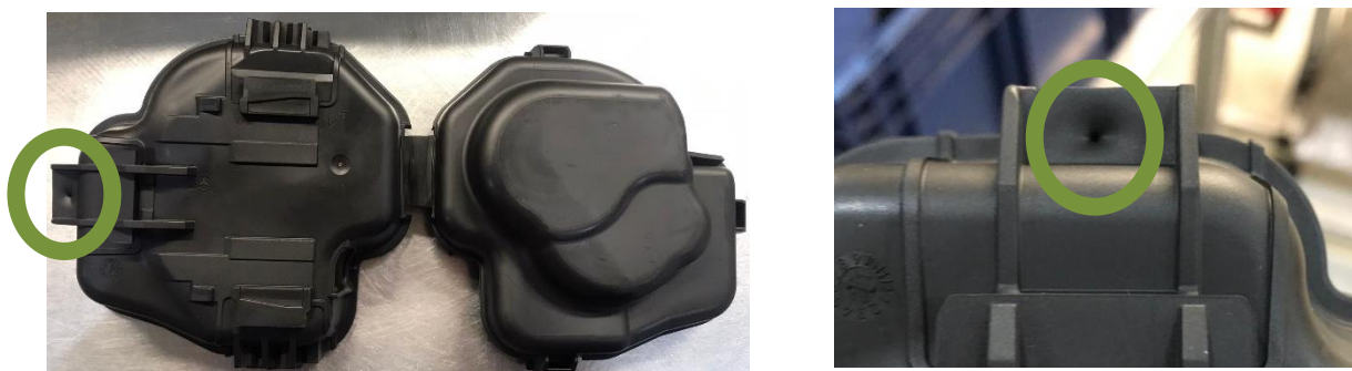
Figura 5.2. Defeito na carcaça (rechupe), visível de dois ângulos diferentes
