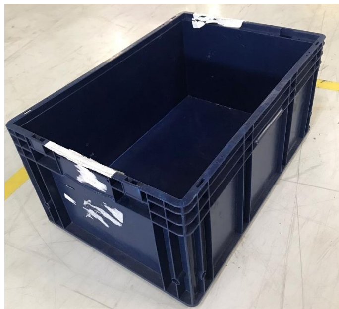
Figura 4.6. KLT para acondicionamento do produto acabado
