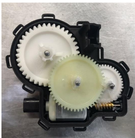
Figura 4.8. Pré-montagem resultante das operações no posto 1
