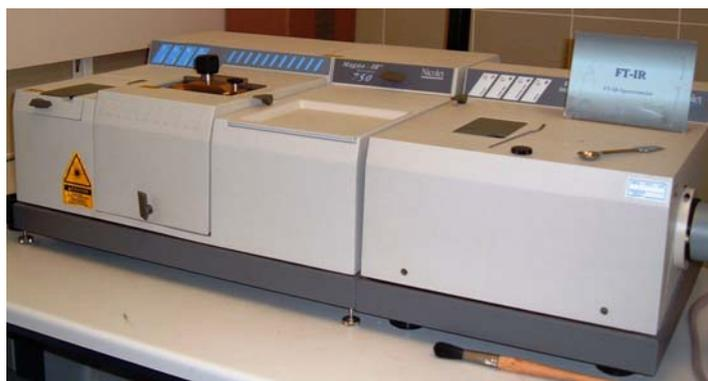
**Figura 3.5:** Equipamento de ATR-FTIR *Magma-IR™ Spectrometer 750*.
