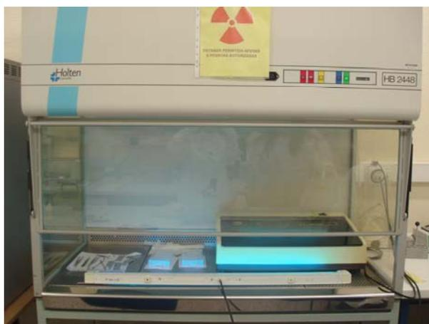
**Figura 3.9:** Aparelho de esterilização U.V. no interior da câmara de fluxo laminar.
