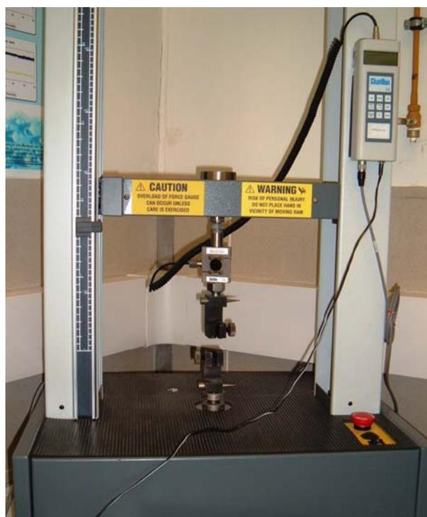
**Figura 3.6:** Máquina universal de ensaios mecânicos *Chatillon™ TCD-1000*.
