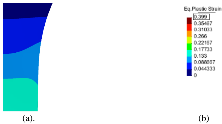
Figura A.1. Distribuição da deformação plástica equivalente para o modelo com espessura constante sujeito à tracção.
