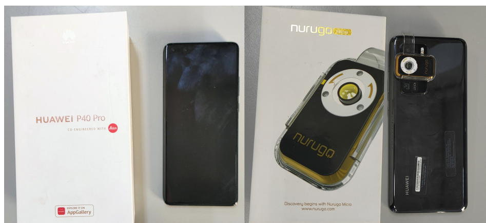
Figura 3.8: À direita: telemóvel Huawei utilizado para a captura de diversas imagens, que possui uma câmara interna sem lente macro. À esquerda: telemóvel Huawei com a adição da lente macro externa Nuguro , também utilizada para a captura de diversas imagens.
