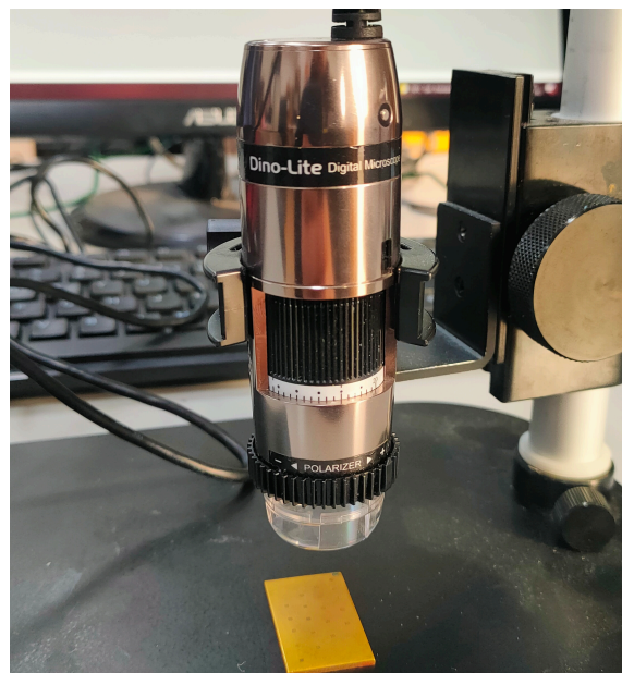
Figura 3.4: Representação do sistema utilizado para capturar as imagens através do microscópio.
