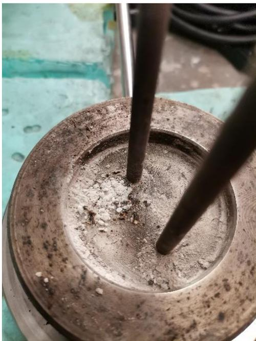
**Figura 4.16 - Depósito de amido de milho nas paredes interiores que não reagiu durante a explosão**
