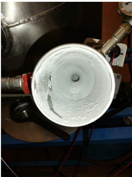
**Figura 4.15 - Interior do recipiente de poeiras após o ensaio**
