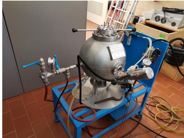
**Figura 3.1 - Câmara de explosão onde se realizaram os ensaios localizado no DEMUC**
