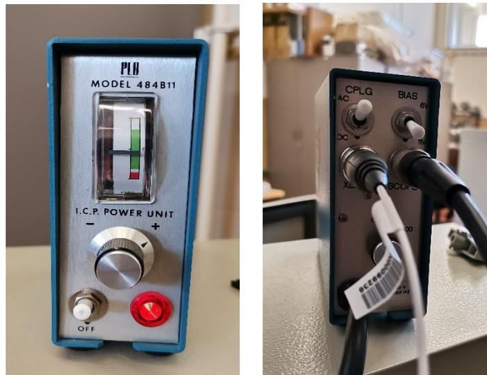
Figura 3.5 - Amplificador de carga (PLB – Model 484B11)
