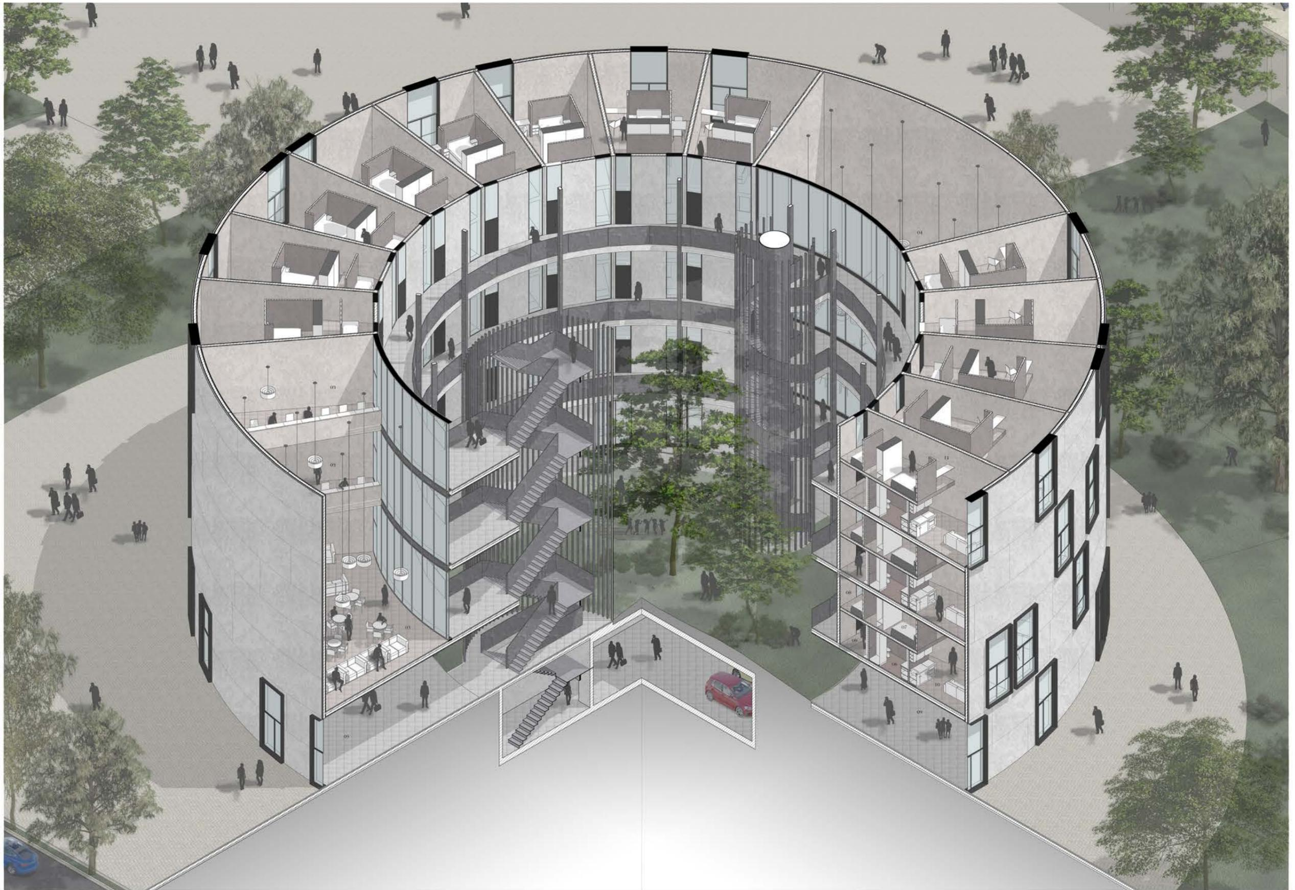
Assimetria Explodida e Construtiva do Edifício tipo de Habitação - Escala 1/75
