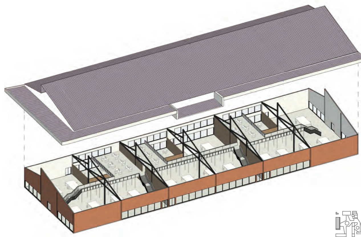
Fig. 51: Axonometria explodida do edifício de Oficinas
