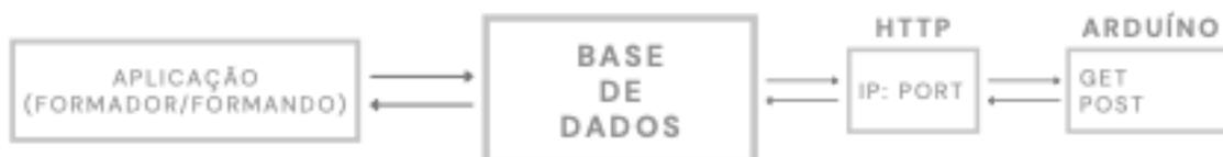
**Figura 5.1:** Possível esquema global do sistema.
