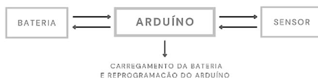
**Figura 4.18:** Esquema da ligação do arduíno aos vários componentes.
