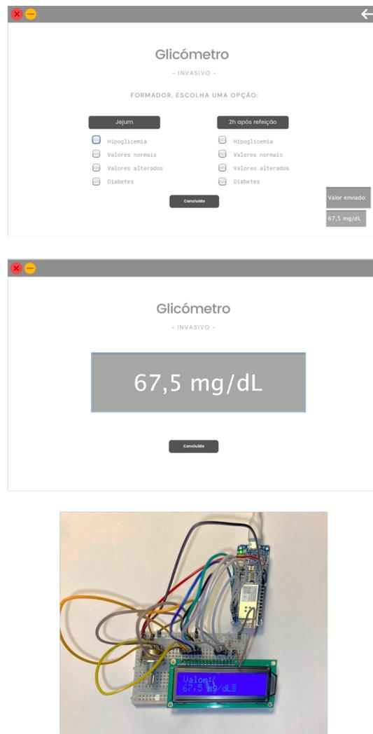
**Figura 4.8:** Aplicação do formador (em cima), formando (no meio) e valor apresentado no LCD (em baixo).
