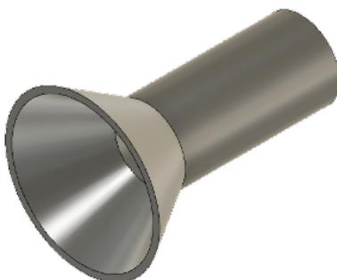
**Figura 4.16:** Modelo da cabeça do estetoscópio realizado no programa *Fusion 360*.
