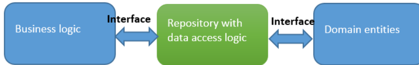
Figura 6.3: Esquema da comunicação entre camadas com o Repository Pattern - fonte [77]
