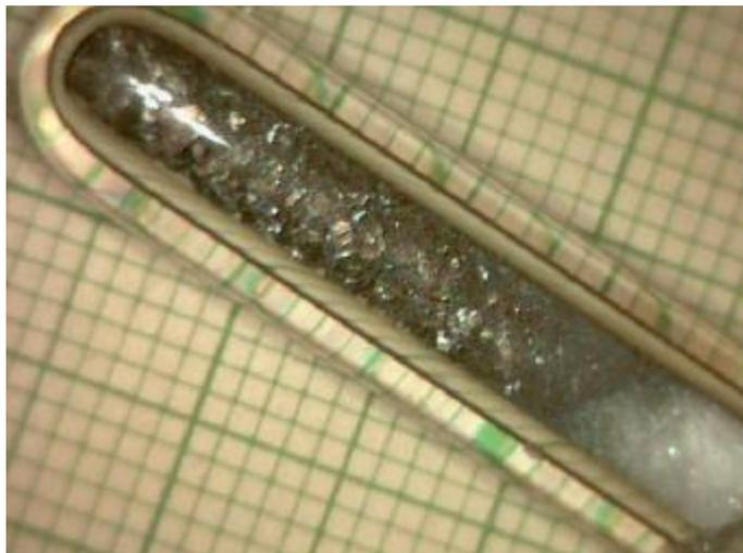
Fig 5.4 – fotografia obtida em microscópio óptico digital do tubo de quartzo utilizado para trabalho no sistema Sievert, onde se pode observar o granulado típico obtido depois de alguns ciclos de carga e descarga de hidrogénio
