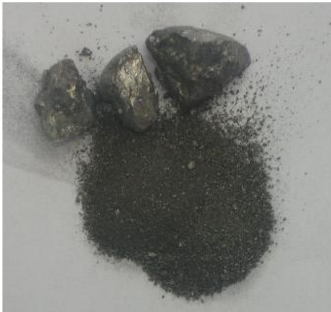
Fig 6.1 – Amostra de  $LaNi_5$ . O material fica pulverizado após o processo de carga de hidrogénio.
