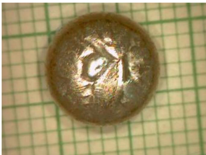
Fig 5.1 – Fotografia obtida em microscópio óptico digital de uma das amostras, em pastilha, após a fundição. A amostra está sobreposta a uma folha de papel milimétrico, para melhor avaliação das dimensões.
