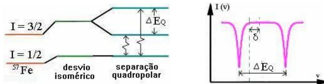
Fig 4.8 - ilustração e espectro observado para a interação quadrupolar eléctrica [9].
