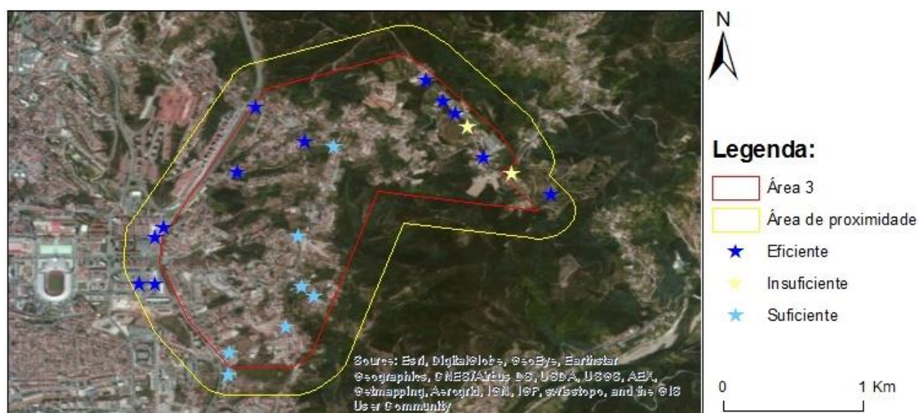
Figura 65 - Distribuição dos resultados da avaliação de eficiência (caudal) dos Macros de Incêndio (Área 3)
