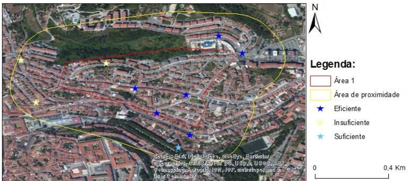
Figura 63 - Distribuição dos resultados da avaliação de eficiência (caudal) dos Macros de Incêndio (Área 1)
