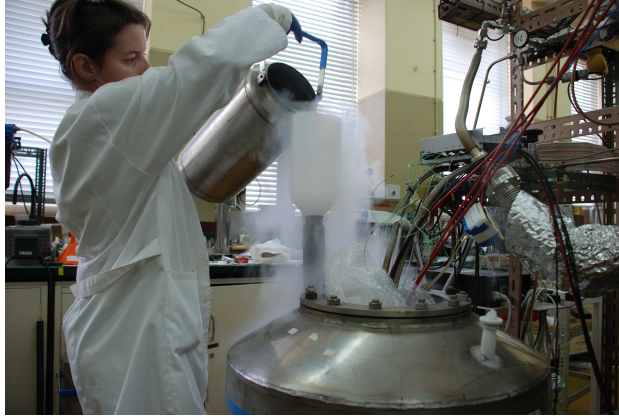
Figura 4.16: Enchimento do crióstato com LN.
