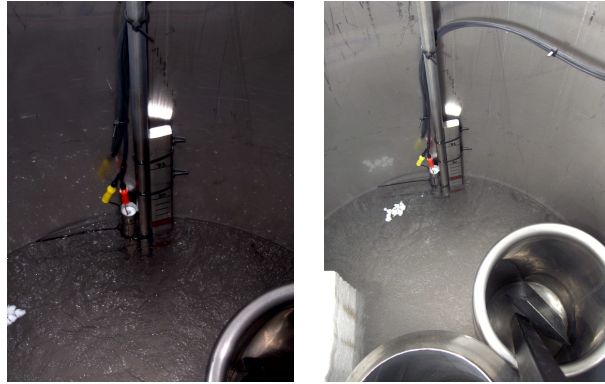
Figura 4.15: Medidor de nível no crióstato aberto durante a calibração.
