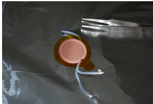
Figura 4.4: GEM com ligações nos eléctrodos.
