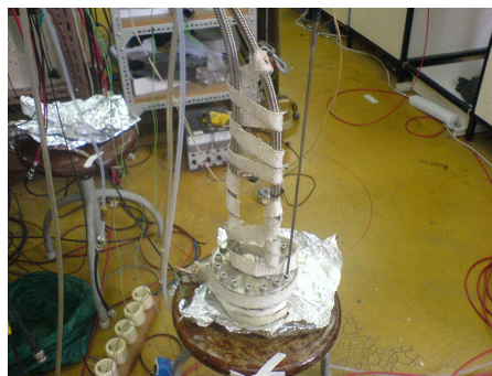
Figura 4.6: Desgaseficação da câmara e tubos de entrada/saída de gás por aquecimento.
