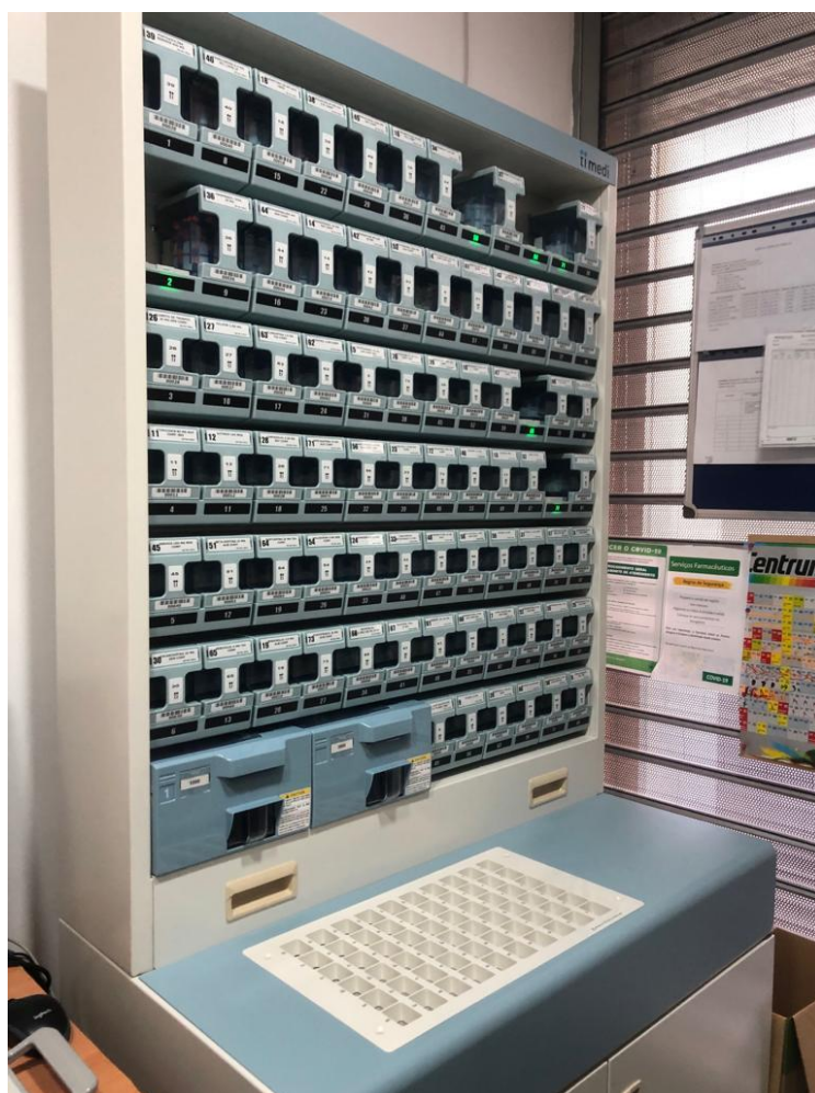
Figura I – Máquina de dispensa automática – ATDPS (Automatic Tablet Dispensing & Packaging System) da marca JVM e saquetas da medicação individualizada.
