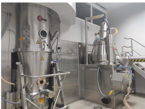
Figura 3 – Sala de Granulação via Húmida
