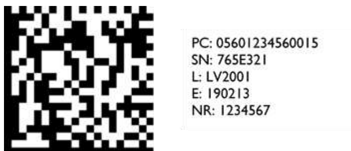
Figura 5 - Identificador Único utilizando o código DataMatrix 2D ( standard GSI ). Fonte: MVO Portugal, 2018a
