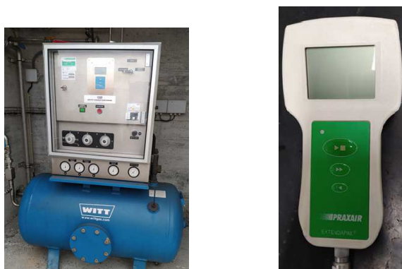
Figura 13 Misturador de gases centralizado (marca WITT modelo KM10-20) e medidor de gases utilizados no âmbito do presente estudo Type Oxybaby M+i O_2/CO_2 modelo: E7.
