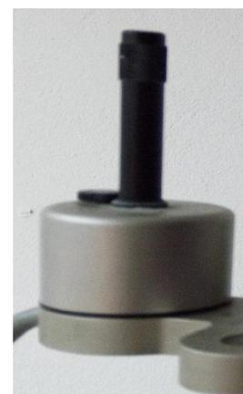
Figura A1 – Sensor de temperatura do bolbo húmido natural
