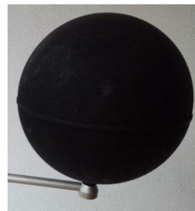
**Figura A3 - Sensor de temperatura do globo negro**
