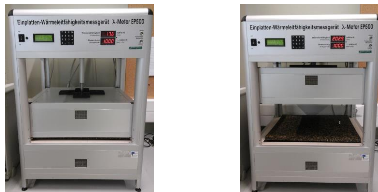
Figura 3. 5-Equipamento single-specimen Lambda-meter EP500 com introdução da amostra
