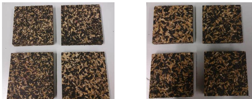
Figura 3. 9 - Amostra do Compósito A com 200 mm x 200 mm e de 150 mm x 150 mm
