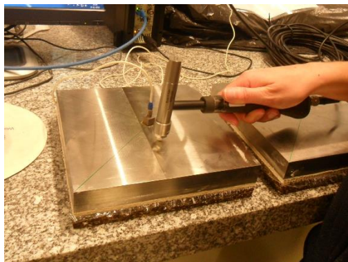
Figura 3. 15 - Ensaio da determinação da rigidez dinâmica
