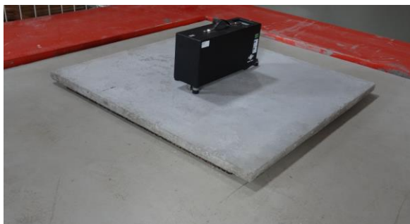
Figura 3. 4 - Máquina de percussão sobre lajeta flutuante
