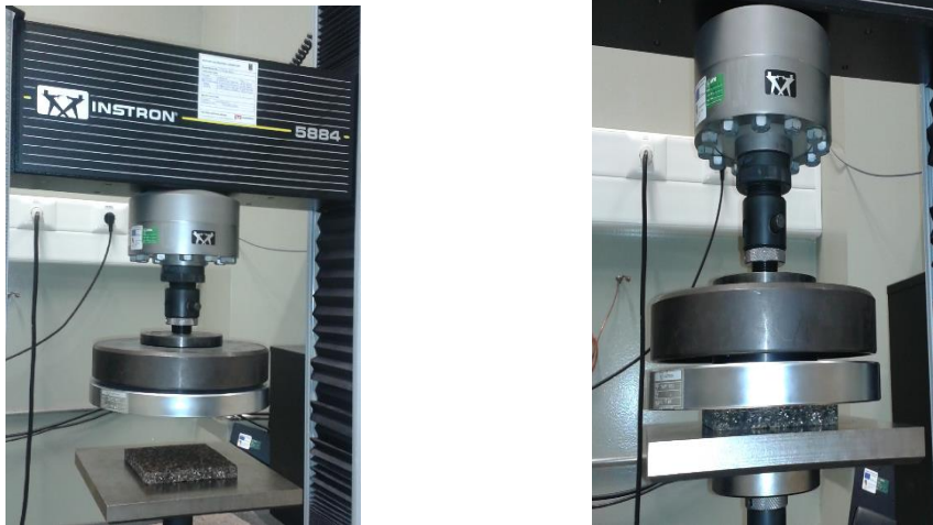
Figura 3. 12 - Rotura do provete no ensaio de resistência á compressão
