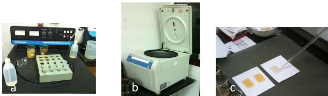
Fig. 21– Procedimento de preparação das amostras para análise mineralógica e granulométrica (a e b – centrifugadoras; c- pipetagem em lâmina de vidro)
