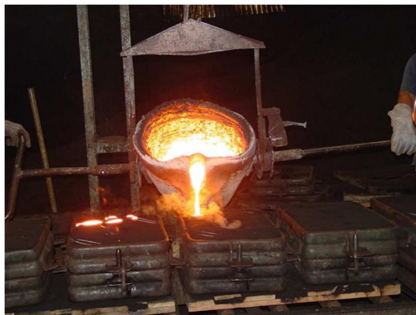
Fig. 3- Processo de vazamento do fundido nos moldes de areia
