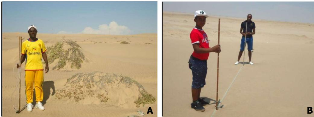
Figura 1.2: A – Instantes ilustrando a preparação do dispositivo de ripas; B – Instantes ilustrando o alinhamento para a medição do perfil longitudinal. Fotos do autor.
