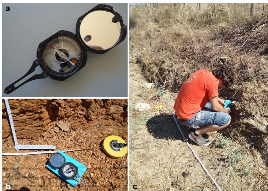
Figura 4.6 – Ilustração esquemática dos materiais utilizados na aquisição de dados de campo. a) Bússola do tipo Brunton com clinómetro; b) Material utilizado durante a aquisição de dados; c) medição de dados de campo.
