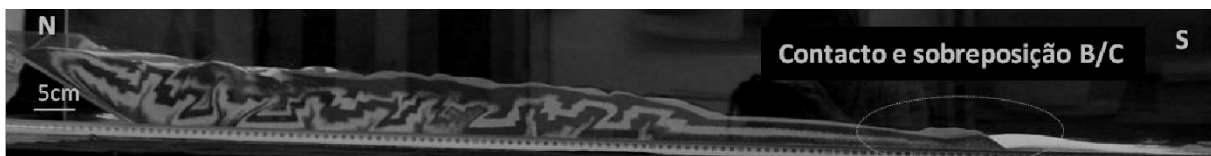
Figura 2.1 – Modelo análogo de caixa de areia. Momento após deformação das unidades mais antigas (Unidade B) e deposição da unidade C (Bolacha & Dias, 2013).
